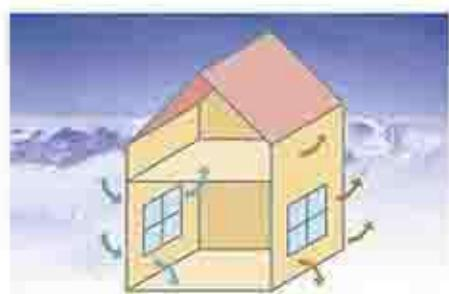
Κατασκευαστικές ατέλειες, όπως παράθυρα, πόρτες και μη στεγανή τοιχοποιία ευθύνονται παλαιότερα, πλέον των σημαντικών απωλειών ενέργειας για τον ανεξέπλεγκτο αυτό-αερισμό των κτιρίων, ο οποίος σήμερα έχει αντικατασταθεί από τον επιεγχόμενο βασικό αερισμό.
